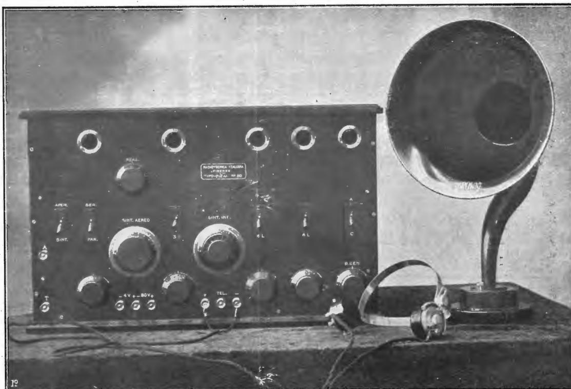
Tutto il ricevitore è montato su pannello frontale di ebanite lucida di 60 x 35 cm., e contenuto in cassetta di legno mogano pulimentato, di 15 cm. di profondità.
